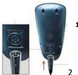
1. zadní strana ovladače 2. nabíjecí
